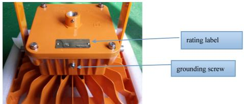
WHEN YOU PUT THE COVER BACK, PAY ATTENTION TO THE MAKE SURE THE SIDE OF BACK COVER WITH THE RATING LABEL IS JUST ABOVE THE GROUNDING SCREW, JUST LIKE THE ATTACHED PHOTO, THIS IS VERY IMPORTANT.
